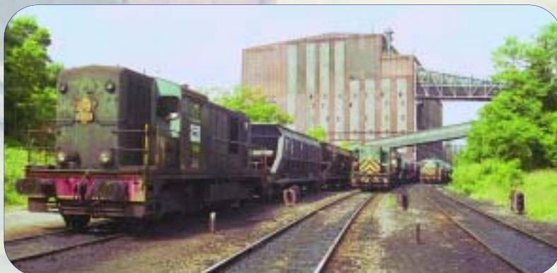
Wagons en cours de chargement tractés par des locomotives radiocommandées
