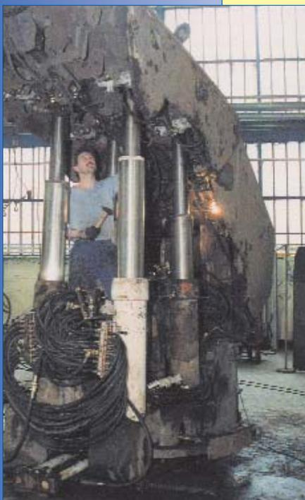
Réparation d'une pile de soutènement
