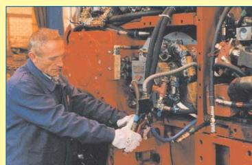
Réglage d'un circuit hydraulique
