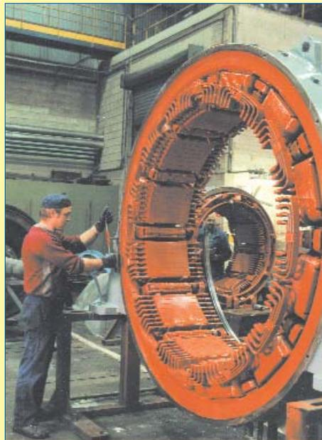
Réparation d'un induit de machine d'extraction
