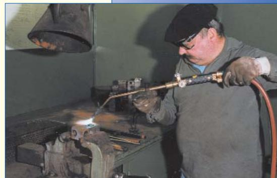
Chauffage d'une pièce pour démontage
