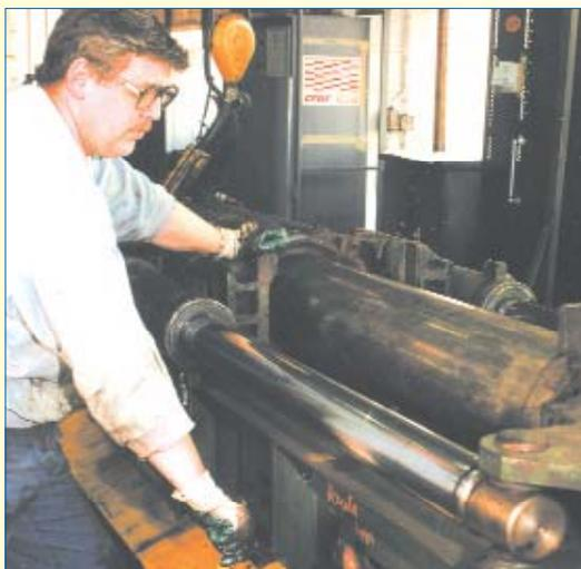
Travaux sur un vérin hydraulique
