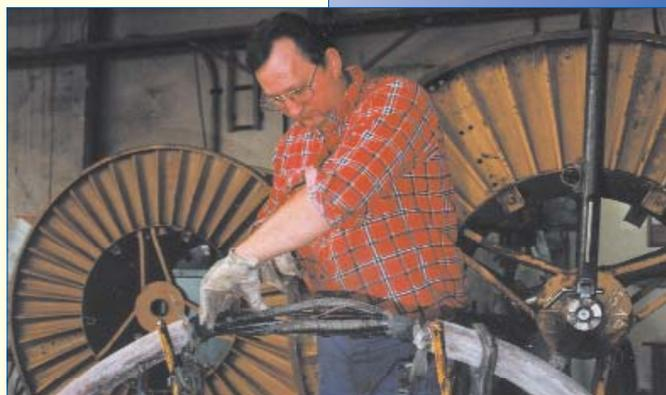
Ouverture d'un tronçon de câble électrique
