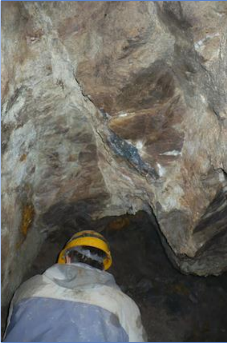
Filon de la Borderie, zone minéralisée en stibine encore en place – Photo P.C. Guiollard.
